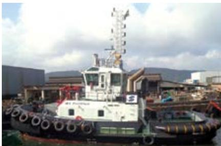
Rebocador WS Phoenix - da série 2411 e possui tração estática (bollard pull) de 72 toneladas
